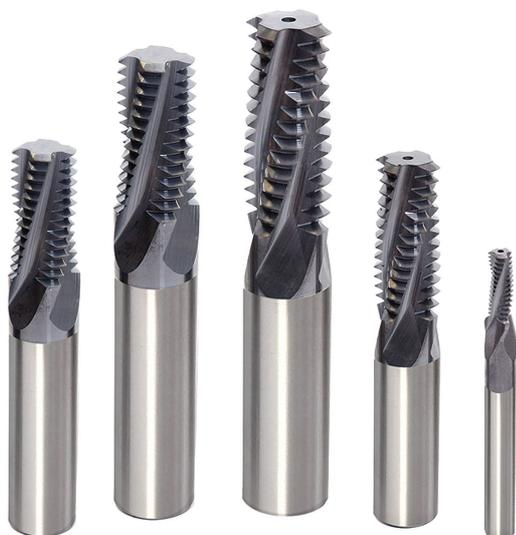
La linea di frese per filettare MaxThread™ in metallo duro sono prodotte sia senza che con foro di refrigerazione centrale. Questi utensili sono rivestiti TiAlN di serie ed offrono eccellenti prestazioni a prezzi competitivi. La recente introduzione del foro centrale di refrigerazione assicura una migliore evacuazione del truciolo.
