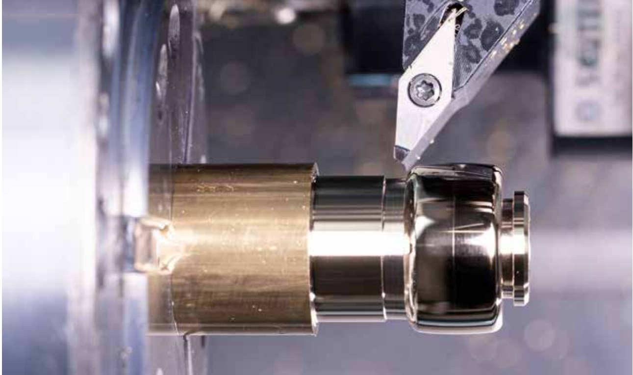
Tornitura a specchio del diametro esterno con un inserto da taglio ISO con punta MCD.
