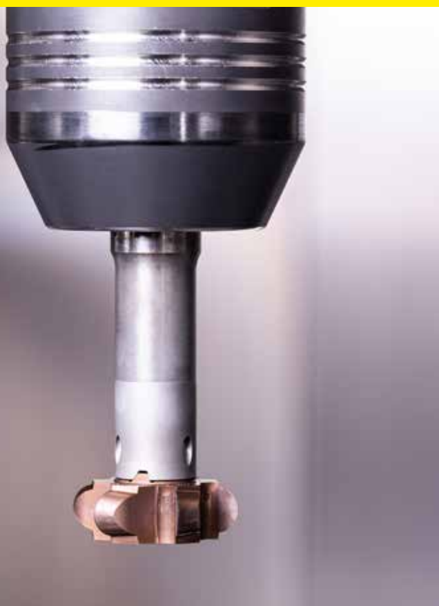
Götz fresa le scanalature con una fresa a raggio pieno.
