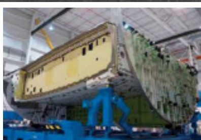
SEZIONE CENTRALE DEL CASSONE ALARE
