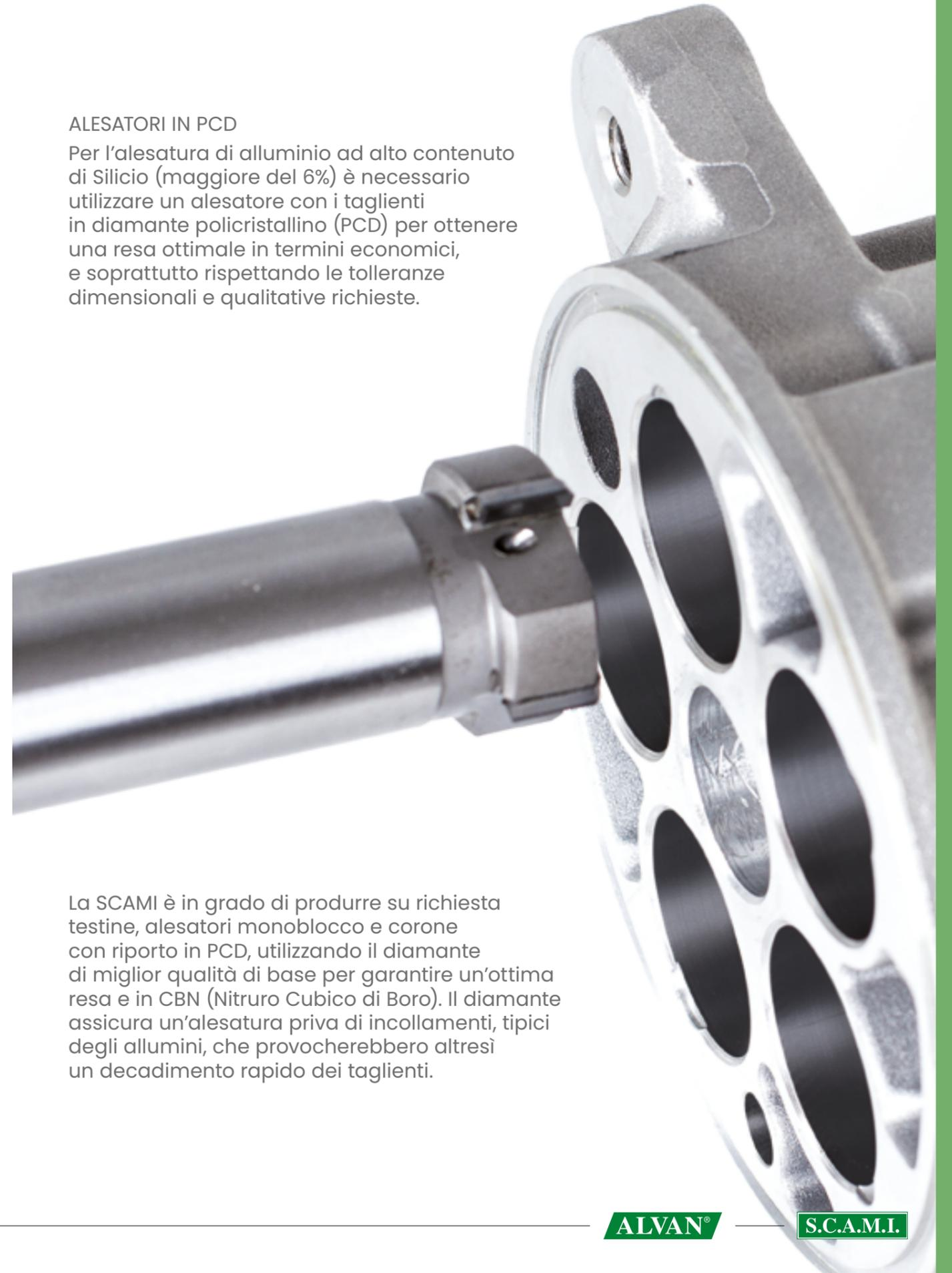
La SCAMI è in grado di produrre su richiesta testine, alesatori monoblocco e corone con riporto in PCD, utilizzando il diamante di miglior qualità di base per garantire un'ottima resa e in CBN (Nitrato Cubico di Boro). Il diamante assicura un'alesatura priva di incollamenti, tipici degli allumini, che provocherebbero altresì un decadimento rapido dei taglienti.
