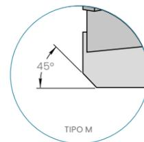
L'imbocco "M" è caratterizzato da una geometria ad alto avanzamento e stabilità incrementata utilizzabile su tagli leggermente interrotti e alesature extra lunghe.
